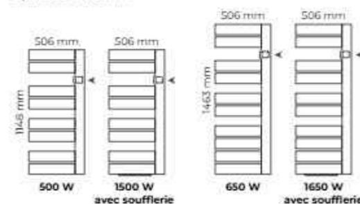
► Emplacement du boîtier de commande sur l'appareil
