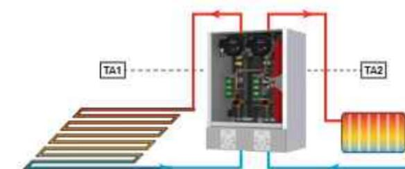
Possibilité de mettre 2 circuits radiateurs et 2 circuits plancher également
