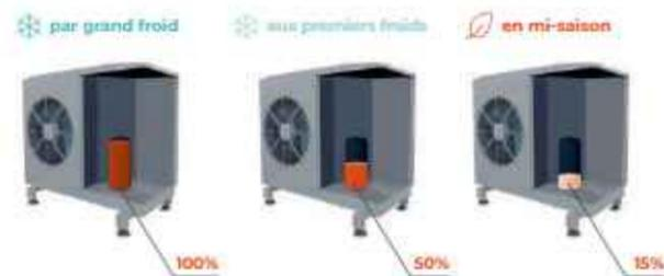
La HTi<sup>70</sup> a un compresseur Inverter qui fait moduler sa puissance de 15 à 100%
