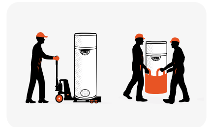
Sac de transport fourni pour faciliter le déplacement du CET jusqu'à son lieu d'installation définitif.
