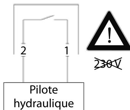
L'entrée de la carte électronique du pilote hydraulique pour le raccordement du thermostat d'ambiance est libre de potentiel (contact sec). Ne pas raccorder d'alimentation électrique.
