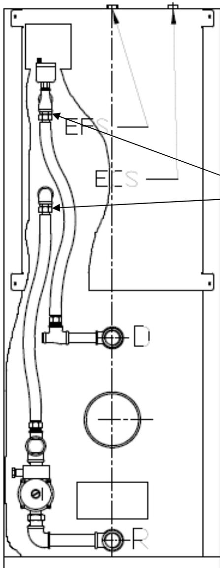
3) Dévisser les 2 écrous tournants (3/4") au niveau des 2 extrémités des flexibles au plus près du ballon
