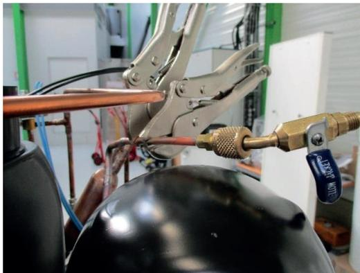
**Etape 7 :** Ouvrir légèrement la vanne pour s'assurer que le pincage du tube est bien étanche, couper la queue de charge à l'aide d'un coupe tube, puis pincer le bout du tube.
