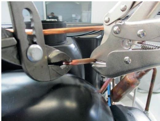
**Etape 8 :** Braser le tube pincé pour assurer l'étanchéité. Retirer les pinces-étau. La charge du chauffe-eau est terminée
