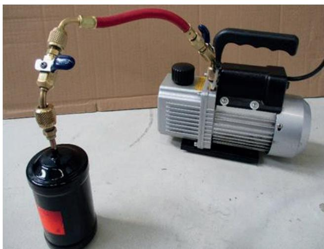
**Etape 4 :** Le flexible étant tiré au vide, fermer la vanne puis débrancher la pompe à vide et raccorder le flexible avec le bouteillon sur la queue de charge BP (type shrader) de l'appareil. Enlever au préalable le flexible ayant servi au tirage à vide.
