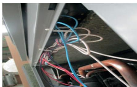
**Étape 6 :** Retirer les 2 vis de fixation situées en haut du compartiment ventilation (photo de gauche) et les 2 vis situées en face avant sur la partie inférieure du panneau (photo due droite) à l'aide d'un tournevis Torx T20. Déposer le panneau en le faisant glisser vers le bas (S'assurer que le ventilateur soit stable dans la machine et qu'il ne puisse pas basculer vers l'avant).
