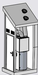
Une sortie mixte en toiture/façade est possible. Pour la sortie toiture, il existe 2 configurations : toit plat et toit incliné.
