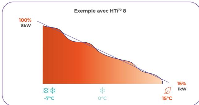
— besoin de chauffage — adaptabilité du compresseur Inverter ■ puissance générée par la PAC 100% thermodynamique
