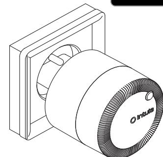
3 FR Branchez la passerelle intuis connect sur une prise de courant accessible (ou multiprise). Assurez vous que celle-ci soit placée au plus proche du premier équipement à connecter, en vérifiant que le réseau WiFi couvre bien la zone.
