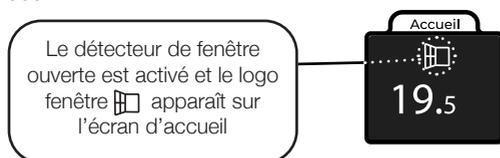
En cas de détection de fenêtre ouverte, le logo fenêtre s'affiche en grand à l'écran et un signal sonore retentit. Un appui sur n'importe quel bouton remettra automatiquement le chauffage en fonctionnement.
