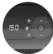
Écran LCD rétro éclairé à intensité réglable
