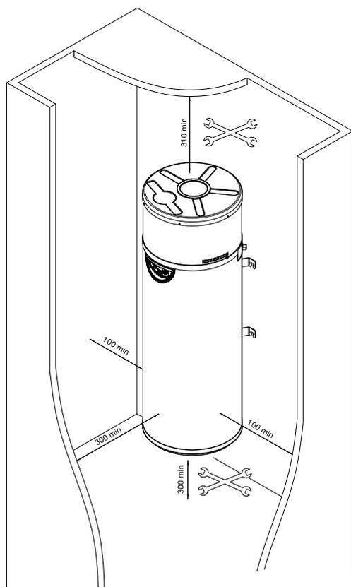
Dans cette configuration, il est recommandé de desserrer les vis latérales de fixation du capot supérieur avant l'installation.
