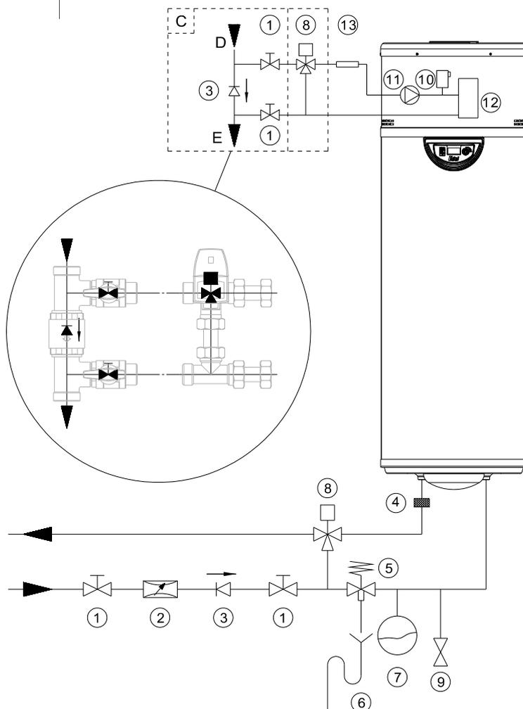
**! Il est recommandé d'installer un filtre sur la tuyauterie d'entrée du chauffe-eau pour protéger le circulateur et l'évaporateur. Il permet de protéger et d'allonger la durée de vie des composants. Un nettoyage minima annuel de celui-ci est nécessaire.**
