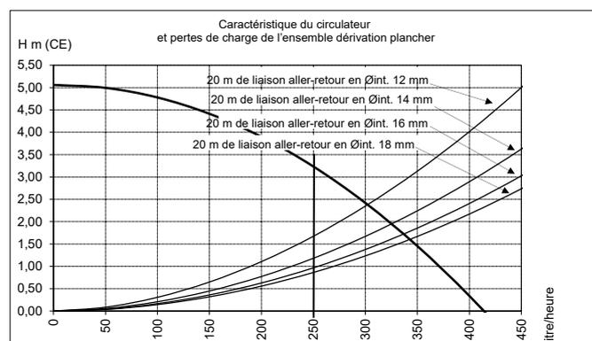
La longueur et le diamètre de la liaison hydraulique aller/retour entre le module de dérivation plancher et le chauffe eau thermodynamique doivent être adaptés au circulateur pour que le débit prélevé dans le plancher soit supérieur à 250 l/h.
