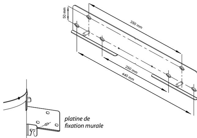
Pour une fixation murale robuste et parfaitement verticale, il convient d'utiliser la (les) platine(s) de fixation murale (en option). Cette platine est pré-percée avec différents entraxes de fixation : 250mm, 350mm ou 440mm. Cela permet d'une part, une fixation murale plus robuste en utilisant si besoin est, 4 points de fixation au lieu de 2, et d'autre part, un pré-positionnement parfaitement horizontal à l'aide d'un niveau.
