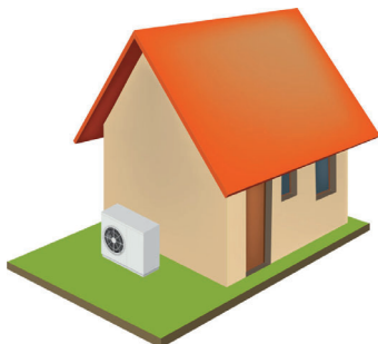
Placée contre un mur +3 dB (A)
