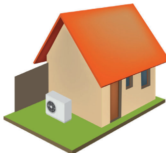
Placée dans un coin +6 dB (A)
