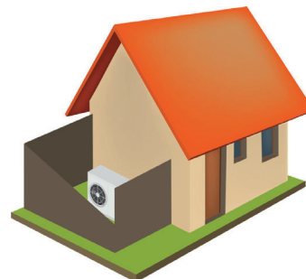
Placée dans une cour +9 dB (A)
