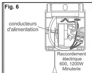
**ATTENTION : ne pas abîmer les conducteurs électriques avec les vis de fixation murale du boîtier de commande**
