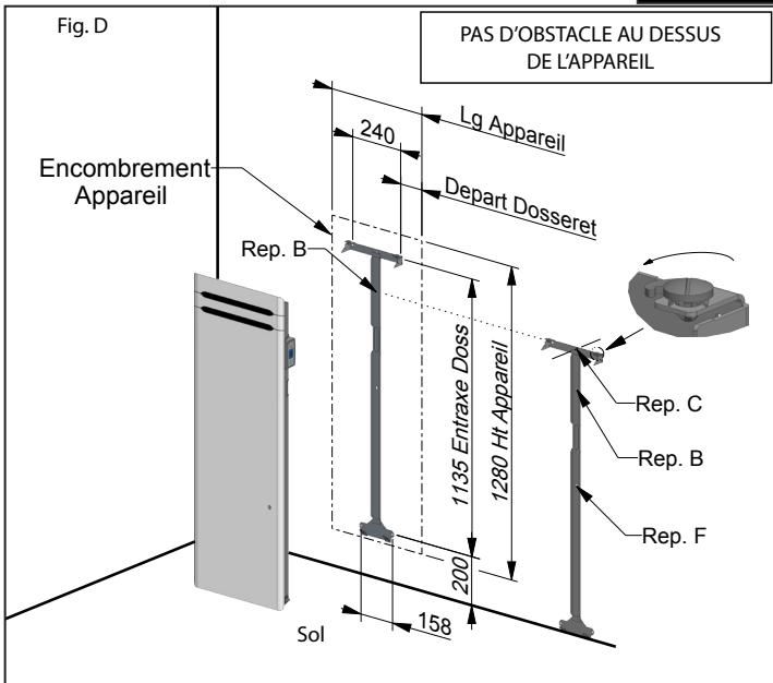
Pour un meilleur maintien de l'appareil au mur, il est possible de rajouter 1 vis de fixation sur le montant du dosseret (Rep. F, Fig. D). Il est recommandé d'utiliser des rondelles pour améliorer la tenue du dosseret.
