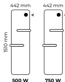
► Emplacement du boîtier de commande sur l'appareil
